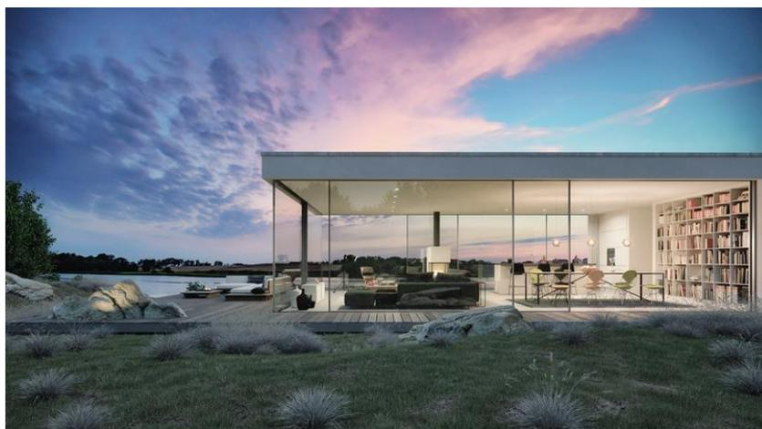
Mit der Serie M von SOREG-glides werden dank kohlefaserverstärkten (Carbon) Profilen Ansichtsbreiten von nur 16 mm realisierbar.
